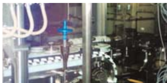
Partikelmessung direkt an der Abfüllung in laminarer Strömung. Particle measurement in the laminar flow right at the point of filling
