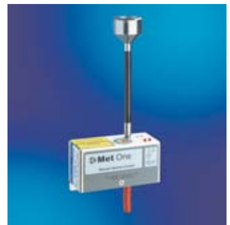
Verwendete Partikelzähler. Messbereich ab 0,5 oder 5 micron bei 1,0 cfm (entspricht 28,3 l/Min.) The particle counter used. Measurement range from 0.5 or 5 microns at 1.0 cfm (corresponds to 28.3 l/min.)
