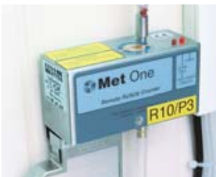
Verwendete Partikelzähler. Messbereich ab 0,5 oder 5 micron bei 1,0 cfm (entspricht 28,3 l/min.) The particle counter used. Measurement range from 0.5 or 5 microns at 1.0 cfm (corresponds to 28.3 l/min.)
