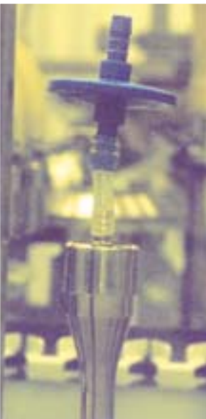
Partikelzähler erfasst Partikel mit 0,5 µm. Particle counter detects 0.5 µm particles.
