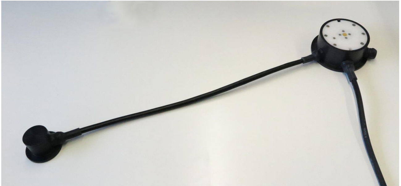
Abbildung 1: ARS31Pro-UMB mit externem Temperatur Sensor
