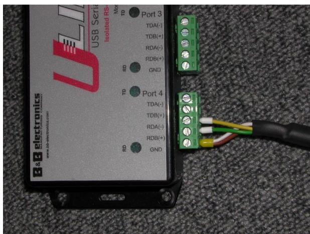
Abbildung 14 RS485 Verbindung zu einem Signalumwandler.
