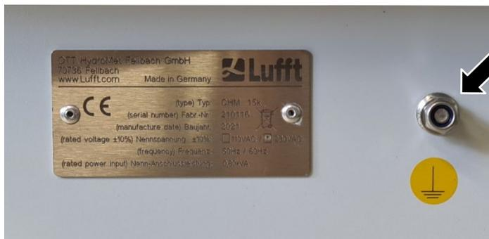
Abbildung 13 Erdungsanschluss am Sockel des Gerätes.
