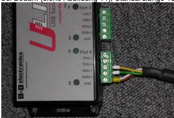
Abbildung 14 RS485 Verbindung zu einem Signalumwandler.
