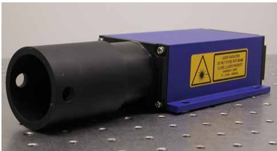
Abb. 30: Sensor LDM30.11 Im Servicefall muss nur dieser Geräteteil im Feld ausgetauscht bzw. zur Reinigung mit ins Labor genommen werden.
