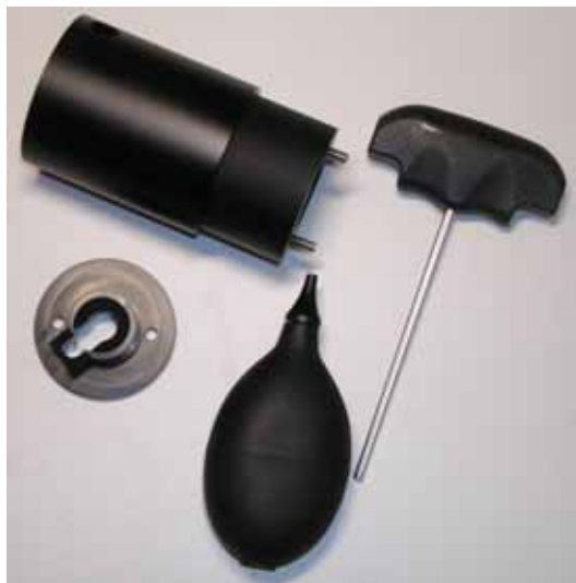
Abb. 29: Reinigungszubehör: Blasebalg (Fotozubehör), Inbusschlüssel mit T-Griff (M3) und entferntes Streulichtrohr mit Blende
