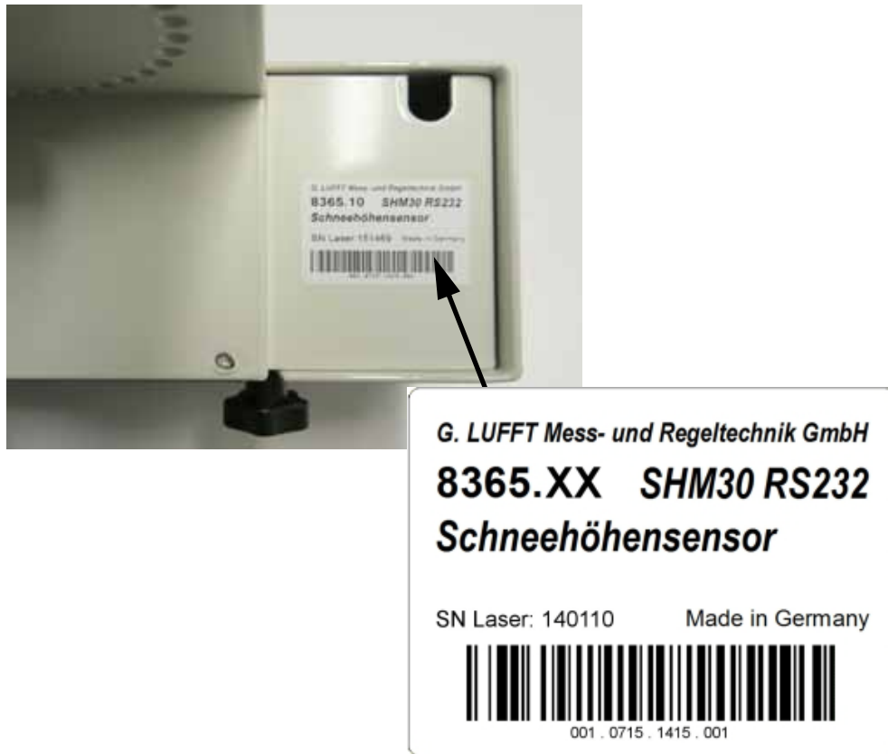
Abb. 2: Typenschild an der Unterseite des SHM 30.
