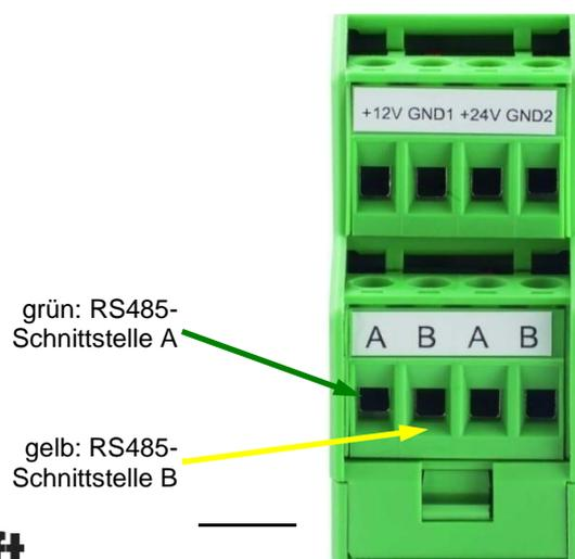
Abbildung 9: Anschluss an Isocon- UMB
