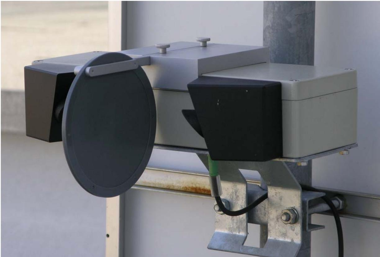
Mit Hilfe des UMB-Config-Tools wird die gemessene Sichtweite abgefragt. **Bitte beachten:** bis die aktuelle Sichtweite ausgegeben wird, dauert es **mindestens 2 Minuten**.
