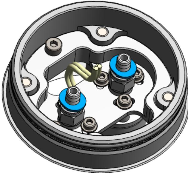
Abbildung: Anschluss Drucksensoren
