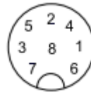
Abbildung 17: Sicht auf Lötanschluss der Kabeldose mit Nut.
