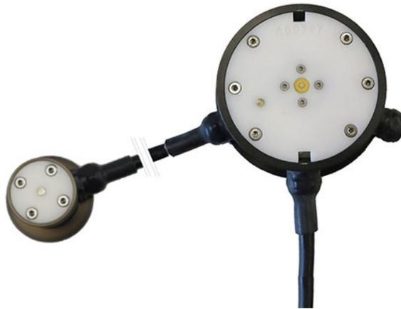
Der aktive Fahrbahn- bzw. Landebahn-Sensor ARS31Pro-UMB ermittelt den gemischunabhängigen Messwert der Gefriertemperatur sowie die Fahrbahnoberflächentemperatur. Einfache Wartung durch zweiteiliges Gehäusekonzept.
