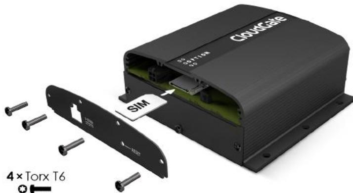
Ein Torx Schraubenzieher T6 wird benötigt um die Seite zu öffnen! Bitte verschließen sie die CloudGate Zentraleinheit nach der Prozedur wieder.
