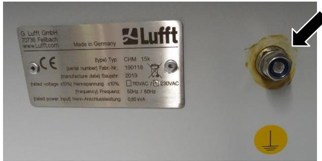
Figura 12 Terminal de puesta a tierra en el zócalo del equipo.
