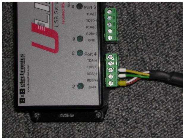
Figura 13 Conexión RS485 a un convertidor de señal.
