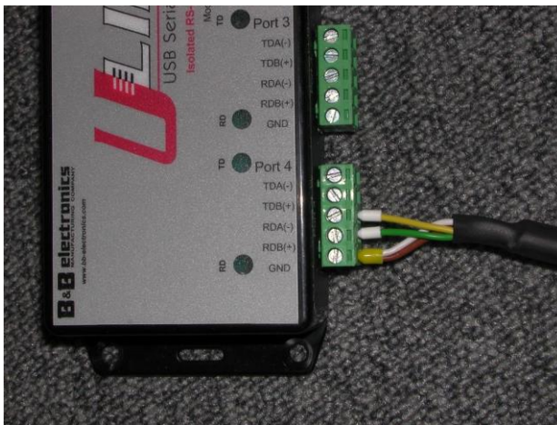
13. ábra RS485 csatlakozás egy jelátalakítóhoz.
