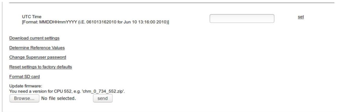
Figura 22 Interfaccia Web: parte inferiore della schermata di configurazione del sistema (modalità Service).
