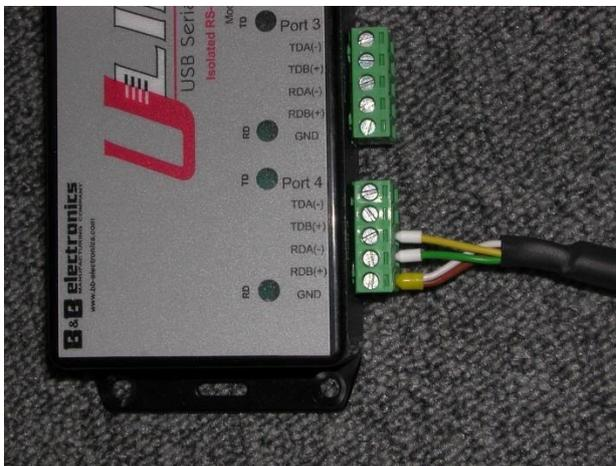
Figura 13: Conexão RS485 a um conversor de sinal.
