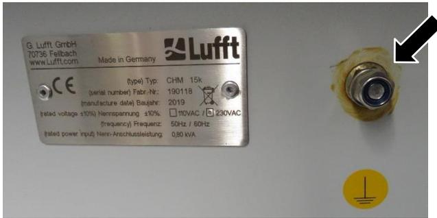
Figura 12: Aterramento na base do aparelho.
