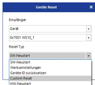
Sous Reset Typ, sélectionnez Custom Reset. Pour réinitialiser la pluviométrie, cliquer sur le bouton Reset.
