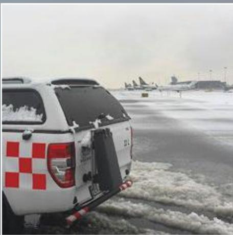
Ideal ist, die gesamte Runway nicht nur in der Länge, sondern auch in der Breite messtechnisch aufzunehmen. Mobile Sensoren wie der MARWIS können dies leisten, indem mehrere Sensoren auf einem Ausleger hinter dem Messfahrzeug installiert werden.
