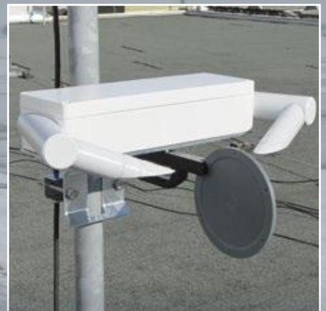
Der Verschmutzungsgrad des Sensors wird zusammen mit den Messwerten ausgegeben und dient als Hinweis für proaktive Wartung.
