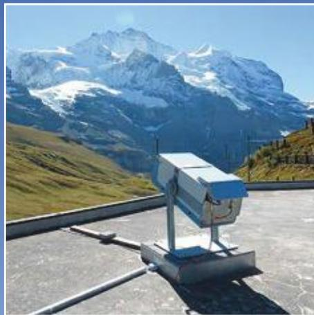
Vor Ort benötigt es Geräte zur Überprüfung der Funktion. Der Luft-Wolkenhöhen Simulator erlaubt die Prüfung der Ceilometer auch bei wolkenlosem Himmel.
