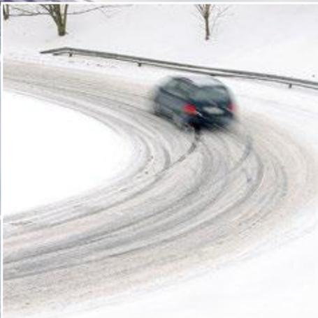
Die Reibung hängt vom Reifen, vom Asphalt und der Wasser-/Schnee-/Eisschicht ab. Entscheidend für die Reibung ist diese wetterbedingte Zwischenschicht.
