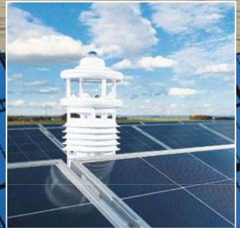
Mit zunehmender Temperatur nimmt die Leistung des Solarmoduls ab. Deshalb ist es wichtig, neben der Lufttemperatur die Temperatur des Solarmoduls zu messen.
