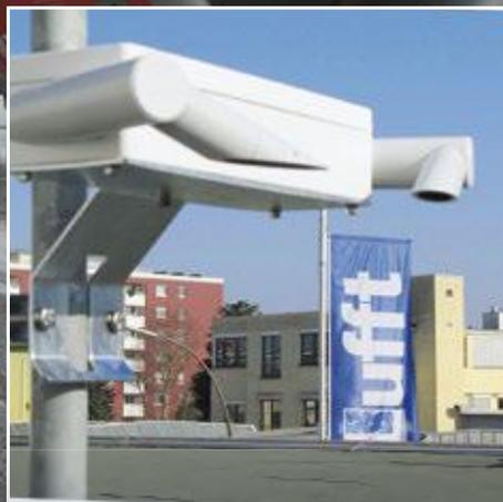
Die Verifizierung im Feld erfolgt durch eine Kalibrierscheibe. Als weiterer Kontrollpunkt wird der Nullpunkt („im Dunkeln“) überprüft.
