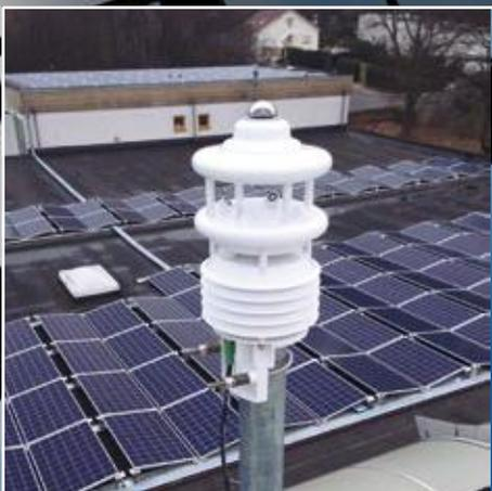
Viele Systemanbieter von Photovoltaik-Anlagen setzen unsere Sensoren weltweit ein. In der Regel werden MODBUS-Schnittstellen zur Messwertübergabe an die PV-Steuerung verwendet. Auf Wunsch integrieren wir herstellerspezifische Protokolle als „plug&play“-Schnittstelle.
