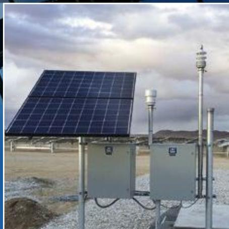
Warum wird in solchen Anwendungen WMO-Standard gefordert? Weil der große Messbereich für Strahlung notwendig ist, um den tatsächlichen Wirkungsgrad der PV-Anlage messen zu können. Und weil die Lebensdauer der Anlage über 10 Jahre betragen soll. Diese Anforderung gilt auch für die Sensorik.
