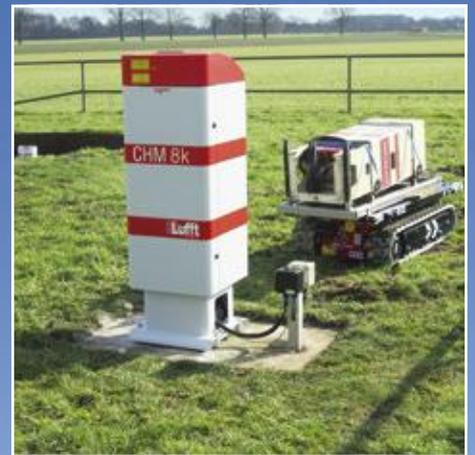
Ceilometer werden häufig dual für die Flughafen-Wetterinformation und die Meteorologie eingesetzt.
