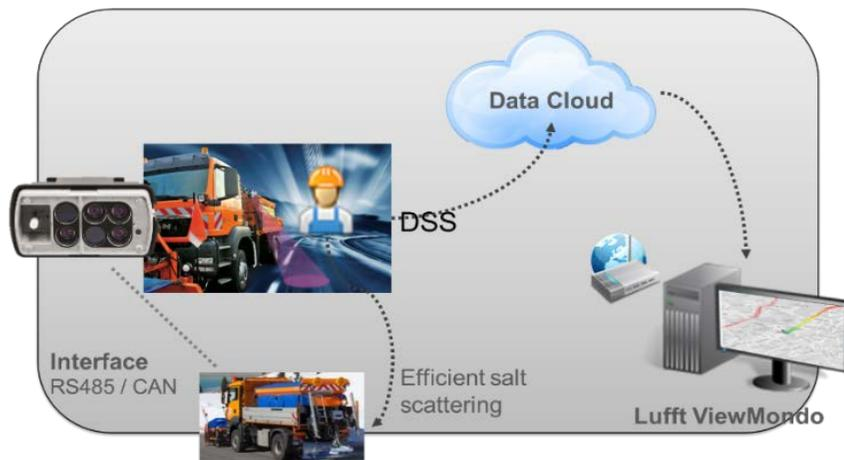
**Abb. 8: Typischer Winterservice-Workflow – von der Datenerfassung bis zur -auswertung**
