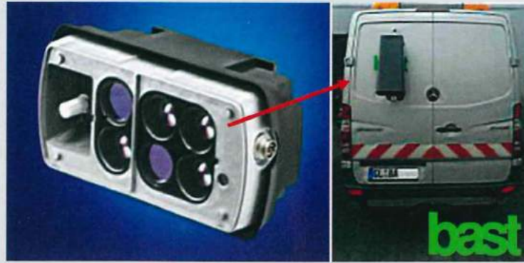
Bild 12: Sensor Typ MARVIS-UMB, Testversion mit Schutzhaube am Fahrzeug der BAST
