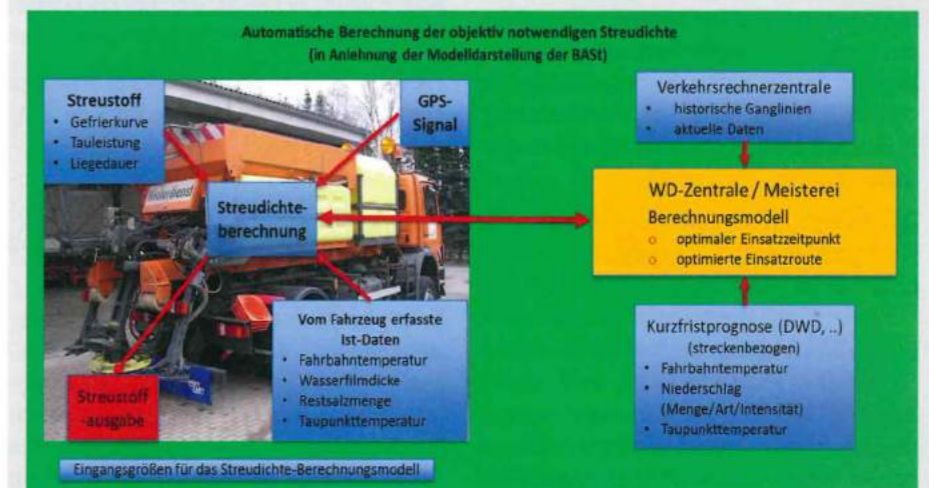
Bild 10: Modelldarstellung „Automatische Streudichteermittlung“ (Quelle: Badelt, BAST)
