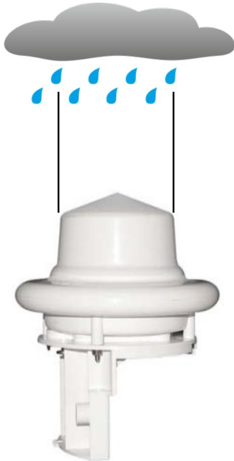
24 GHz Mikrowellen-Dopplerradar misst anhand der Korrelation von Tropfengröße und -geschwindigkeit die Niederschlagsmenge bzw. die Niederschlagsintensität.
