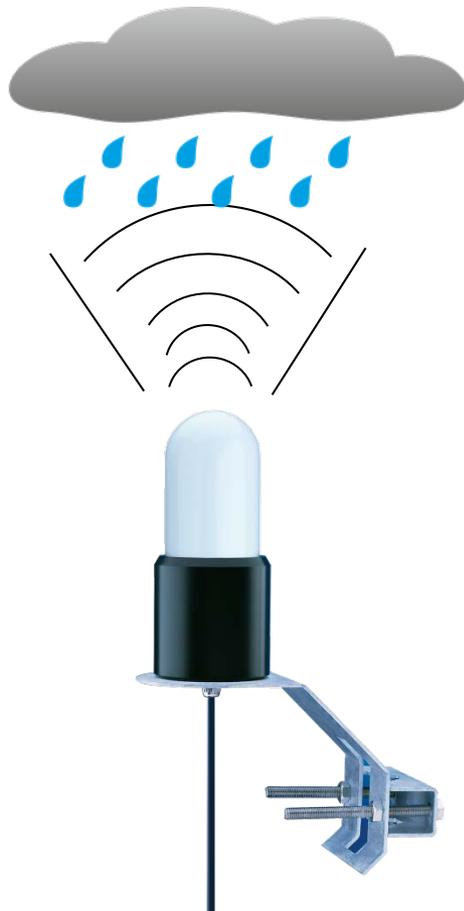
24 GHz Mikrowellen-Dopplerradar misst anhand der Korrelation von Tropfengröße und -geschwindigkeit die Niederschlagsmenge bzw. die Niederschlagsintensität.
