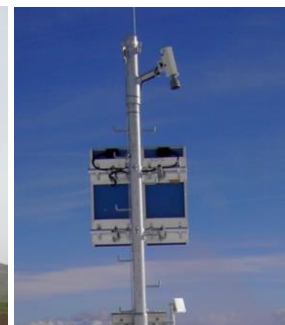
Solarbetriebene SHM30 Schneehöhen-Messanlage
