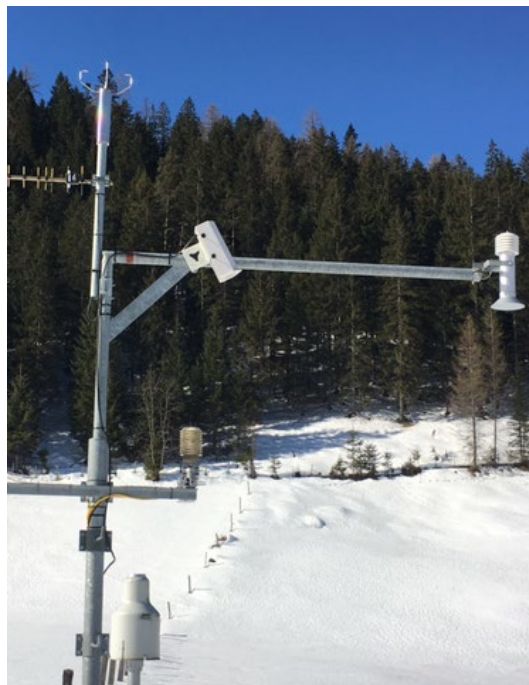
Vergleich von Lufft SHM31 & Ultraschallsensor. Quelle: Wiener Wasser, AT (2018)
